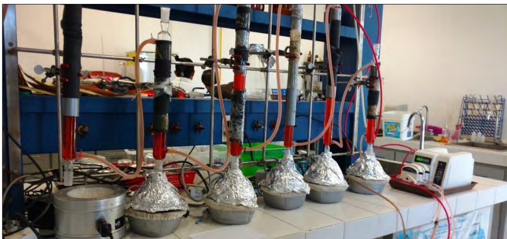
Figura 2. Montaje de experimento para la extracción de bitumen.
